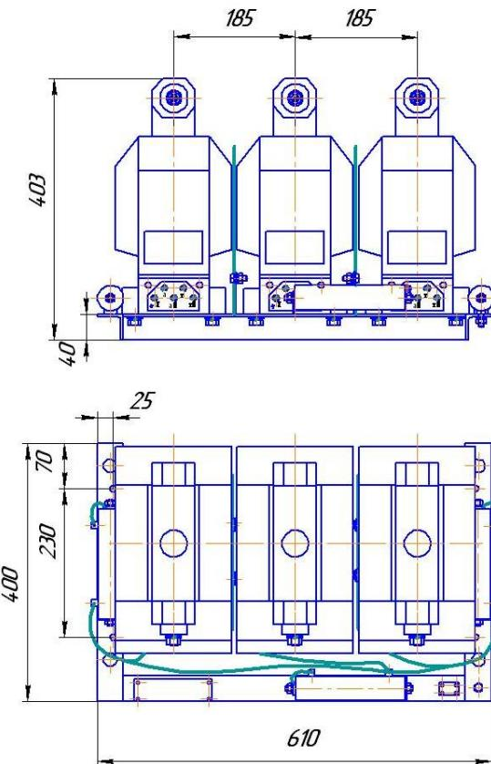
1 В трехфазную трансформаторную группу собираются трансформаторы на напряжение 10 кВ.
