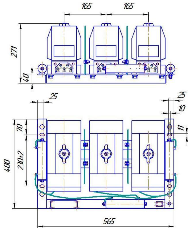
1 В трехфазную трансформаторную группу собираются трансформаторы на напряжение до 10 кВ.
